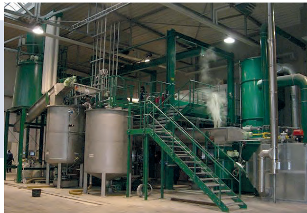
Установка с Flottweg Sorticanter® для сепарации полиолефинов из смешанных пластиков в немецкой компании
